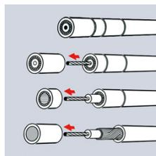
Трехступенчатое удаление изоляции с коаксиального кабеля
