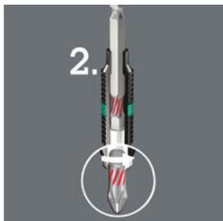
Более высокие пики нагрузки минимизируются эффектом скручивания тела бита (фаза 2). Этот эффект достигается путем целенаправленной термообработки после закалки бита, которая снижает твердость тела по сравнению с наконечником бита.
