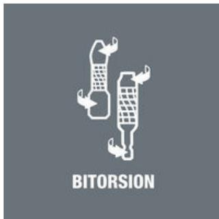
Возникающие при машинном закручивании пики нагрузки способствуют преждевременному износу насадок или разрушению винтов. Если эти нагрузки свести к минимуму, закручивание станет более продуктивным и надежным. Система Wera BiTorsion защищает от преждевременного износа. Срок службы инструмента увеличивается, значительно возрастает производительность при машинном закручивании.
