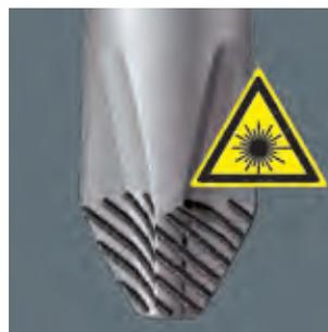
Часто при завинчивании отвёртка выскальзывает из винта. Иногда при этом повреждается ценная поверхность или дело даже кончается травмой. В отвёртках Wera наконечник Lasertip обработан лазером до микроскопической шероховатости. Такая шероховатая поверхность буквально „врезается“ в головку винта. О случайном соскальзывании отвёртки можно забыть.
