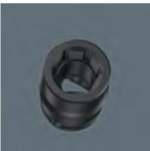
Шестигранный профиль служит для передачи больших усилий и воздействует на грани гайки или головки винта меньше, чем профиль в форме двойного шестигранника. Кроме того, трещотки с тонким механизмом зацепления благодаря малому углу возврата
