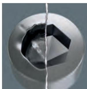
Проблема винтов с внутренним шестигранником состоит в том, что опорные поверхности, передающие усилие с отвертки на винт, очень узкие. Поэтому головка винта может разрушаться. Отвертка с профилем Hex-Plus имеет довольно большую опорную
