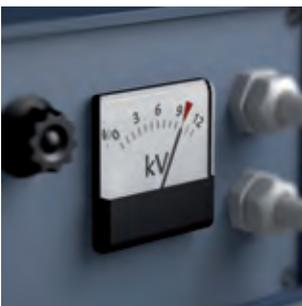
Пштучная проверка под напряжением 10000 В по стандарту IEC 60900 гарантирует безопасность работы под напряжением до 1000 В.
