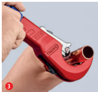
3 Начините рез, постепенно регулируя положение режущего диска специальным синим вентиляем на конце рукоятки ...
