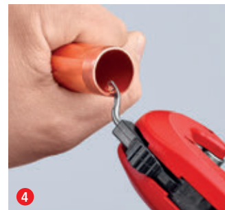
4 Опционально: по завершении реза, по мере необходимости, удалите заусенцы с кромки трубы при помощи гратоснимателя. Это не займёт много усилий!
