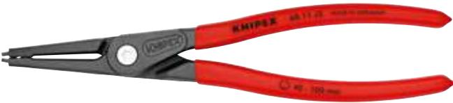
Щипцы прецизионные с запрессованными наконечниками для внутренних стопорных колец, прямые губки, посадочный размер  $\varnothing$  40–100 мм, диаметр наконечников  $\varnothing$  2,3 мм, L – 225 мм, Cr-V, чёрные, обливные рукоятки
